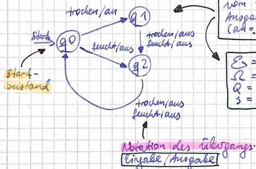
Bewässerungsanlage, Eingabe vom Sensor (feucht/trocken), Ausgabe an die Pumpe (an = „an für 15“, aus = „aus für 1 min“)
